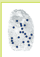
Vom Fingerabdruck über die Merkmalsextraktion zum einzigartigen digitalen Fingercode
